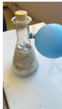
Figura 3 – Reação de alumínio com NaOH, liberando H 2 e fazendo a bexiga inflar
