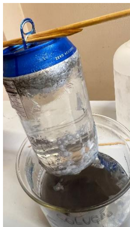
Figura 2 – Lata de alumínio corroida, expondo a película plástica interna
