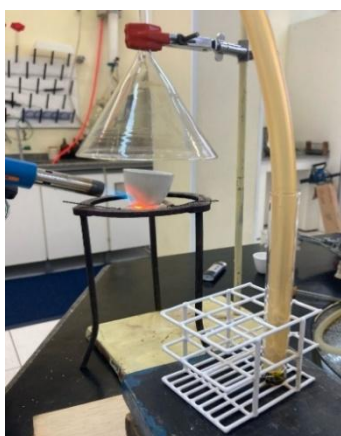
(Imagem 2: equipamento montado para aquecer \text{CaCO}_3 e recolher \text{CO}_2 )
