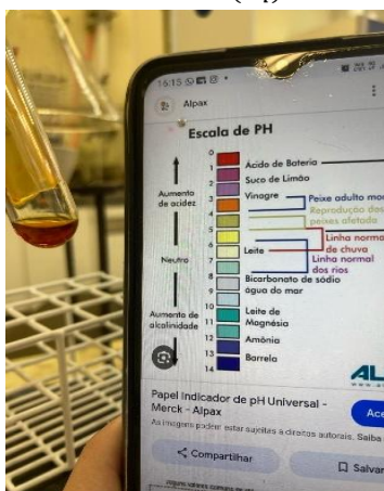
(Imagem 4: à esquerda, \text{CO}_2 em solução de indicador universal comparado à escala do pH [4], na direita)
