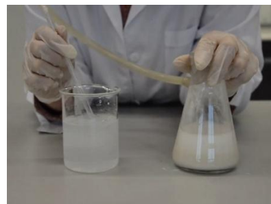
Fig. 5 – No erlenmeyer, há, inicialmente, \text{Ca}(\text{HCO}_3)_2 e, no béquer, \text{Ca}(\text{OH})_2 , ambos conectados por um tubo. Fig. 6 – Já tendo adicionado \text{CH}_3\text{COOH} ao erlenmeyer, produzindo assim \text{CO}_2 , o gás perpassa pelo tubo e reage com o hidróxido de cálcio. Fig. 7 – Com o passar de alguns minutos, a reação de \text{Ca}(\text{OH})_2 e \text{CO}_2 passa a formar o precipitado \text{CaCO}_3 , resultando na mudança de coloração da substância, antes incolor, para esbranquiçada.
