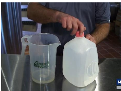
Fig. 8 – No recipiente à esquerda, encontra-se \text{NaOH} em solução aquosa – ocorrendo dissociação iônica, liberando o cátion \text{Na}^+ e o ânion \text{OH}^- – e, no recipiente à direita, \text{CO}_2 . Fig. 9 – A soda cáustica é despejada no recipiente com dióxido de carbono, que, então, é fechado. Fig. 10 – \text{CO}_2 é absorvido pela soda cáustica, formando \text{Na}_2\text{CO}_3 e \text{H}_2\text{O} , com isso, cria-se um vácuo no recipiente, comprimindo-o.
