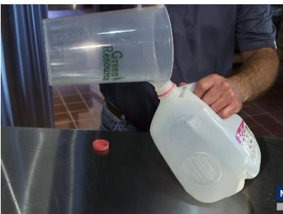
Fig. 8 – No recipiente à esquerda, encontra-se \text{NaOH} em solução aquosa – ocorrendo dissociação iônica, liberando o cátion \text{Na}^+ e o ânion \text{OH}^- – e, no recipiente à direita, \text{CO}_2 . Fig. 9 – A soda cáustica é despejada no recipiente com dióxido de carbono, que, então, é fechado. Fig. 10 – \text{CO}_2 é absorvido pela soda cáustica, formando \text{Na}_2\text{CO}_3 e \text{H}_2\text{O} , com isso, cria-se um vácuo no recipiente, comprimindo-o.
