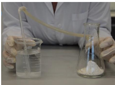
Fig. 5 – No erlenmeyer, há, inicialmente, \text{Ca}(\text{HCO}_3)_2 e, no béquer, \text{Ca}(\text{OH})_2 , ambos conectados por um tubo. Fig. 6 – Já tendo adicionado \text{CH}_3\text{COOH} ao erlenmeyer, produzindo assim \text{CO}_2 , o gás perpassa pelo tubo e reage com o hidróxido de cálcio. Fig. 7 – Com o passar de alguns minutos, a reação de \text{Ca}(\text{OH})_2 e \text{CO}_2 passa a formar o precipitado \text{CaCO}_3 , resultando na mudança de coloração da substância, antes incolor, para esbranquiçada.
