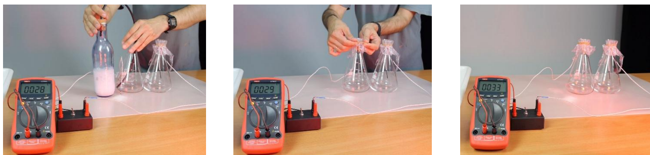
Fig. 1 – Um erlenmeyer foi preenchido por CO 2 , este produzido através da reação de ácido acético e bicarbonato de sódio em outro recipiente, que também produz acetato de sódio e água. Dada a equação: CH 3 COOH (aq) + NaHCO 3 (s) → CO 2 (g) + H 3 CCOONa (aq) + H 2 O (l). Enquanto o segundo erlenmeyer foi preenchido com ar atmosférico, para fins comparativos. Fig. 2 – Agora, ambos têm suas bocas cobertas. Fig. 3 – Com uma lâmpada que emite luz infravermelha (simulando luz solar), os erlenmeyers apresentaram diferentes variações de temperatura: o primeiro, com CO 2 , apresentou uma variação de até 5°C em comparação ao segundo, com 36°C e 31°C, respectivamente.
