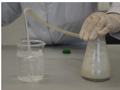
Fig. 5 – No erlenmeyer, há, inicialmente, \text{Ca}(\text{HCO}_3)_2 e, no béquer, \text{Ca}(\text{OH})_2 , ambos conectados por um tubo. Fig. 6 – Já tendo adicionado \text{CH}_3\text{COOH} ao erlenmeyer, produzindo assim \text{CO}_2 , o gás perpassa pelo tubo e reage com o hidróxido de cálcio. Fig. 7 – Com o passar de alguns minutos, a reação de \text{Ca}(\text{OH})_2 e \text{CO}_2 passa a formar o precipitado \text{CaCO}_3 , resultando na mudança de coloração da substância, antes incolor, para esbranquiçada.
