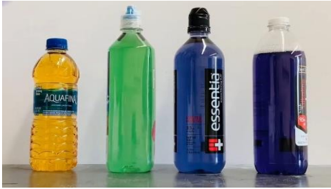
Figura 4: Da esquerda para a direita, o conteúdo de água nas garrafas apresentou o pH entre 6, 8, 9 e 10, de acordo com os valores das cores do indicador [10].
