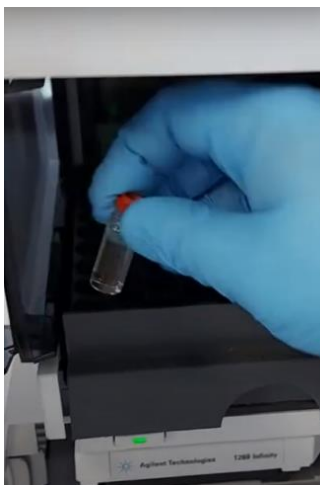
Figura 6: introdução da amostra no equipamento
