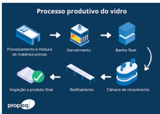
Figura 1: Ilustração das etapas do processo de produção do vidro. [3]
