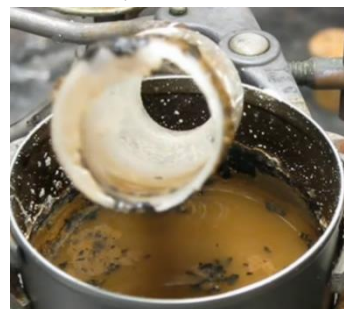
Figura 10 10 : Pote de vidro com o fundo corroído pelo hidróxido de sódio
