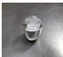
Figura 2 - Mistura com a composição do vidro
