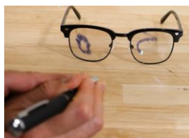
Imagem 2. Lente fotocromática em contato com a luz de 405 nanômetros de comprimento de onda. Disponível em: < https://youtu.be/LsaNkL6it8 > Acesso em: 15/02/2023
