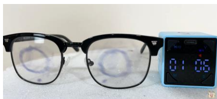
Imagem 5. Lente fotocromática um minuto após o contato com a luz de 405 nanômetros de comprimento de onda. Disponível em: < https://youtu.be/ILsaNkL6it8 > Acesso em: 15/02/2023
