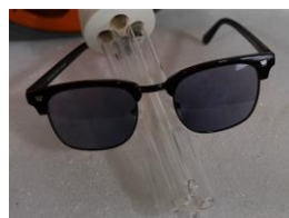
Imagem 4. Lente fotocromática após o contato com a luz ultravioleta. Disponível em: < https://youtu.be/LsaNkL6it8 > Acesso em: 15/02/2023
