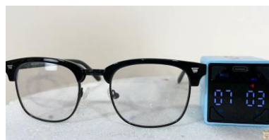
Imagem 6. Lente fotocromática sete minutos após o contato com a luz de 405 nanômetros de comprimento de onda. Disponível em: < https://youtu.be/ILsaNkL6it8 > Acesso em: 15/02/2023
