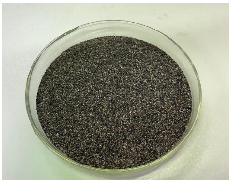
Figura 1 – Beneficiamento da areia descartada de fundição
