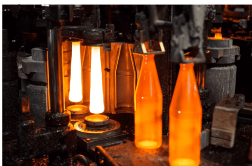
Imagem 1: modelagem de garrafas durante a fabricação do vidro;
