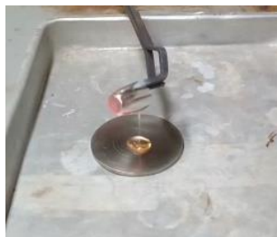
Figura 3: Vertimento da mistura vítrea derretida em placa metálica para a formação de vidro.
