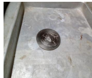
Figura 4: Formação do vidro após resfriamento rápido e prensaagem.
