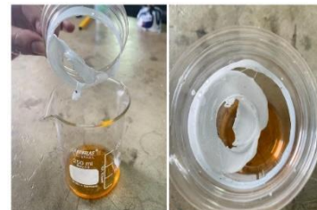
Figura 14: corrosão do plástico pelo ácido.
