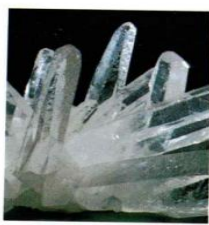
FIGURA 5.20 (a) O quartzo é uma forma cristalina da sílica, SiO 2 , com os átomos em um arranjo ordenado, representado aqui em duas dimensões. (b) Quando a sílica fundida se solidifica, torna-se vidro. Agora, os átomos formam um arranjo desordenado.
