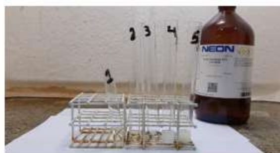
Figura 4 – Resultado da adição de ácido clorídrico 37% aos metais
