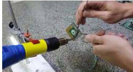
Figura 2 – Remoção dos pinos revestidos de ouro do processador
