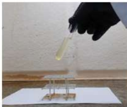
Figura 8 – Oxidação e complexação do ouro pela solução de água régia.
