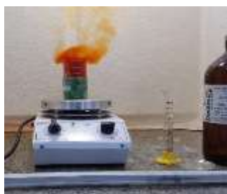
Figura 6 – Oxidação a quente dos metais presentes nos pinos revestidos de ouro do processador.
