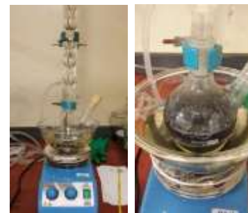
Figura 2. Esquema do sistema de refluxo utilizado na lixiviação da bateria alcalina [7].
