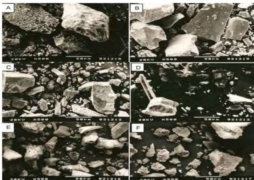
Figura 4 II – Micrografias resultantes de reações químicas envolvendo a A. ferrooxidans , em diferentes condições.
