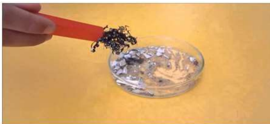
Figura 2 III – Extração de metais ferrosos por separação magnética.
