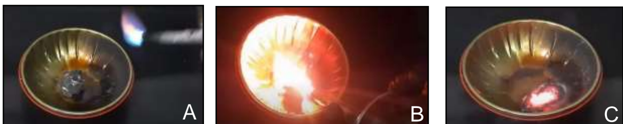
Figura 5 A, B e C- (A) capa de alumínio com o óxido de lítio-cobalto e carbono antes presentes dentro da bateria de íon-lítio expostos à um maçarico. (B) gases provenientes da combustão gerada pelo maçarico criam um ambiente explosivo. (C) lítio-cobalto pós queima, como ocorreria se houvesse uma situação de curto ou combustão na natureza.
