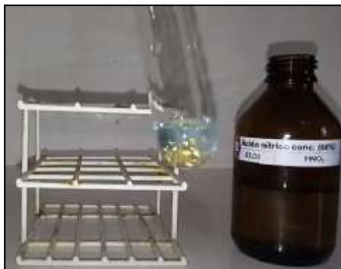
Figura 8 - Ouro sem reação com o ácido nítrico [7]
