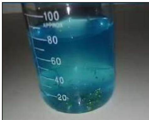
Figura 7 - Flocos de ouro sem os outros metais [7]
