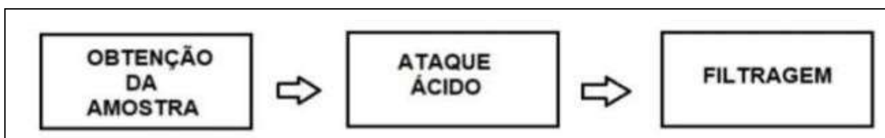
Figura 2 - Fluxograma simplificada do processo de hidrometalurgia [4]
