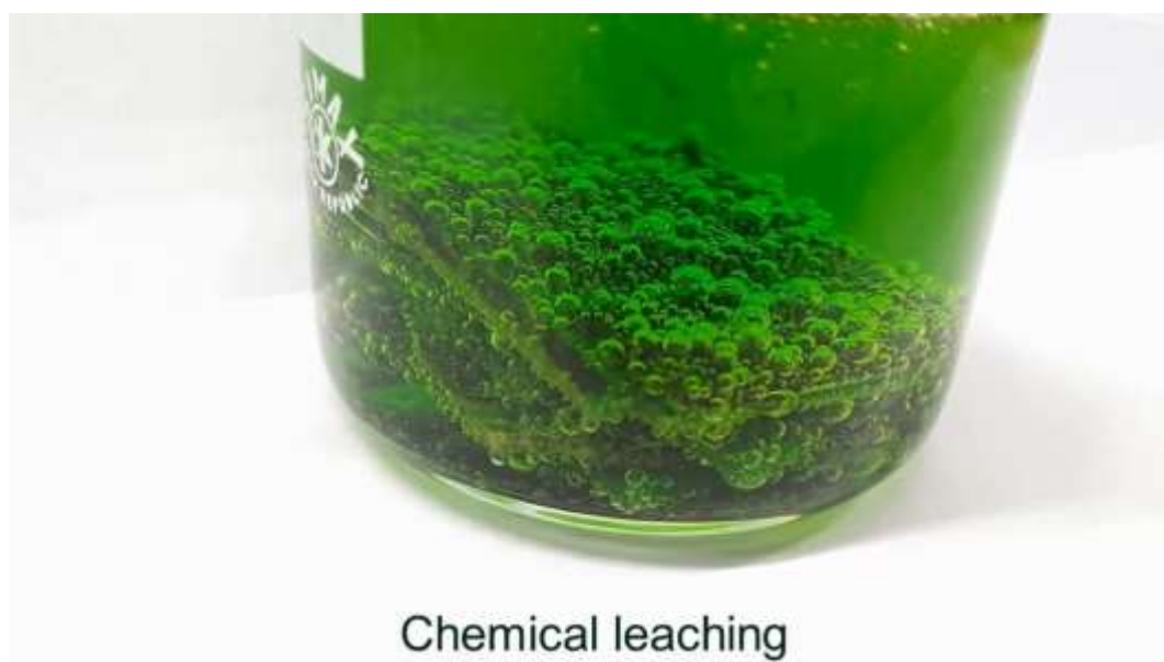
Figura 1. Imagem retirada de vídeo “FENIX hydrometallurgical process”, que ilustra o processo de lixiviação ácida de placas de circuito eletrônico.
