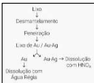
Figura 6 - Parte do processo de hidrometalurgia do Au.
