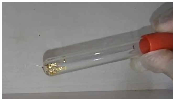
Imagem 1: Terminais metálicos (liga de cobre com 10% a 20% de ouro (Au)) [7]
