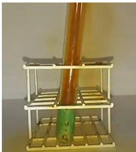
Imagem 2: Reação da liga metálica com o HNO 3 (gás NO 2 altamente tóxico sendo liberado) [7]
